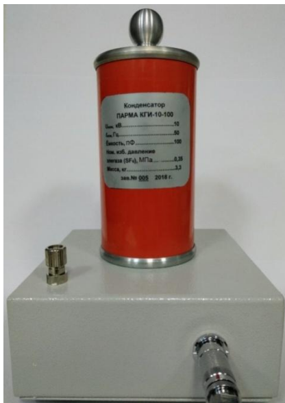
Рисунок 1 Внешний вид конденсатора «ПАРМА КГИ-10-100»
